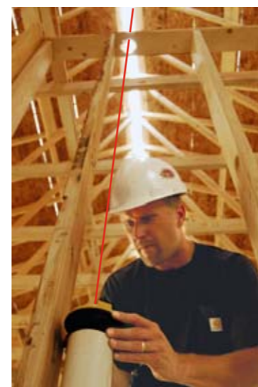
V2R: Klein wie eine Frühstück-Box, die halbrunde Form lässt sich bequem mit der beleuchteten Dosen-Libelle im Rohr ausrichten, ein Knopfdruck und der Laser schießt sein Lot an die Decke.
