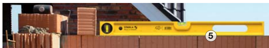
1 Zwei gefräste Messflächen für bequemes Anlegen in jeder Situation. 2 Fest vergessene Libellen. Das STABILA-Patent macht Nachjustieren überflüssig. 3 Messgenauigkeit in Normallage ± 0,029° = 0,5 mm/m. 4 Abriebfeste Skala mit cm-Maßangabe. 5 Große Grifföffnungen – leichte Handhabung.
