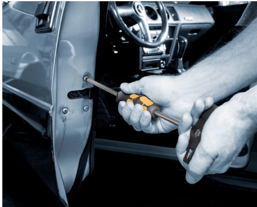
Der Schraubmeißel mit Innenvierkant für noch mehr Kraftübertragung.
