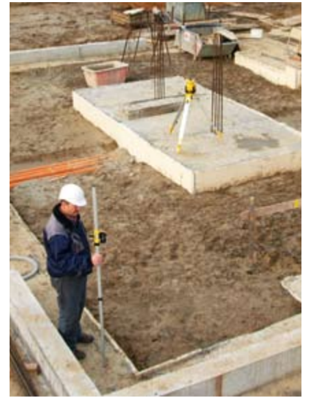
Arbeitsbereich mit Receiver bis 180 m.
