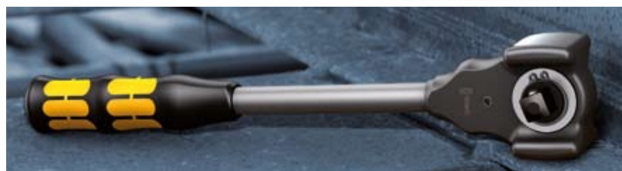
Der „Koloss“ ist ein vollwertiger Hammer mit gesenkgeschmiedetem, zinkphosphatiertem Hammerkopf. Damit der Vierkant beim Hämmern nicht beschädigt wird, weicht er beim Schlagen automatisch aus. Die Hammerbahnen sind gepliestet und können wahlweise mit einem Schon-Pad geschützt werden.
