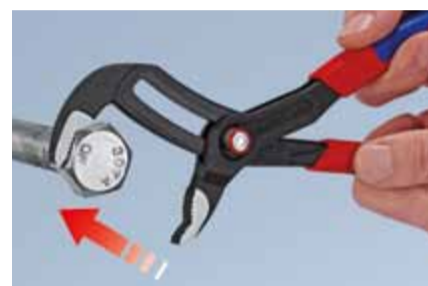
Maul anlegen – Zange einfach zuschieben
