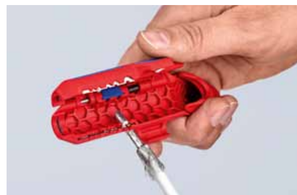
Abisolieren eines Koax-Kabels.
