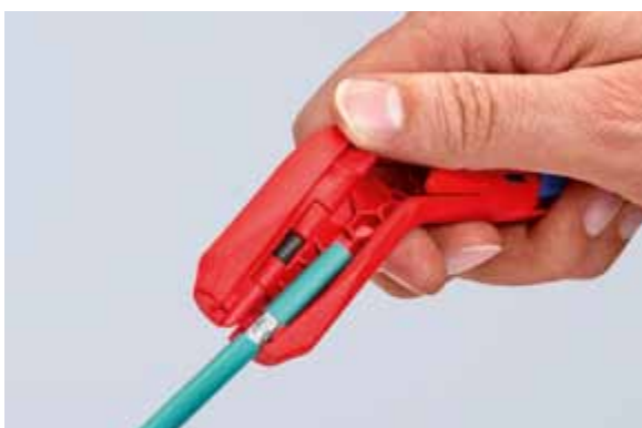
Abmanteln eines Datenkabels
