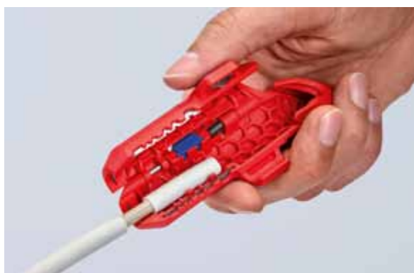
Abmanteln eines NYM-Kabels
