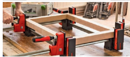
Rahmen spannen: Korpuszwingen + Rahmenpressen-Set KP
