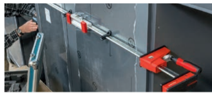
Spannweite vergrößern: Korpuszwingen + Verlängerung KBX
