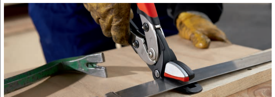
BESSEY bietet mit der Erdi Sicherheits-Bandeisenschere D123S die einzige einhändig bedienbare Bandeisenschere auf dem Markt, die sogar gehärtete Stahlbänder bis 560 N/mm 2 von 32 mm Breite und 1 mm Stärke durchtrennt. Damit deckt sie mehr als die Hälfte aller gängigen Verpackungsbänder ab.
