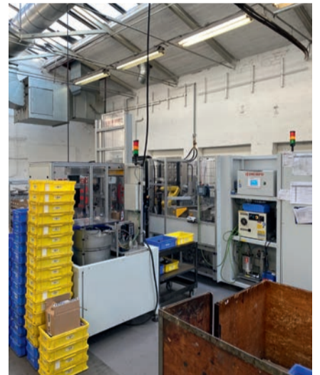
Die neue Rohrstielmontageanlage gewährleistet eine automatisierte und passgenaue Montage der einzelnen Komponenten der PICARD Latthämmer.
