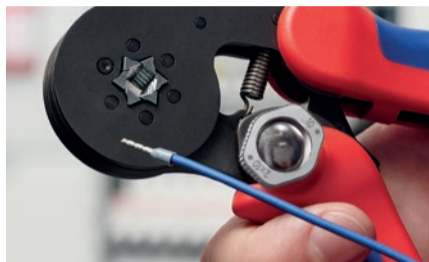
Auch für feine Litzen: verpresst feindrähtige Leiter bereits ab 0,08 mm 2 .
