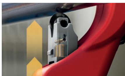
Fixiert: Nach dem Ansetzen verhindert das abgefedernte Schneidrad jedes seitliche Abrutschen.
