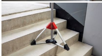
Die GS zertifizierte Deckenstütze STE300 mit 1.700 – 3.000 mm Verstellweg und 3,8 kg Eigengewicht kann je nach Auszugslänge zwischen 350 und 110 kg belastet werden.
