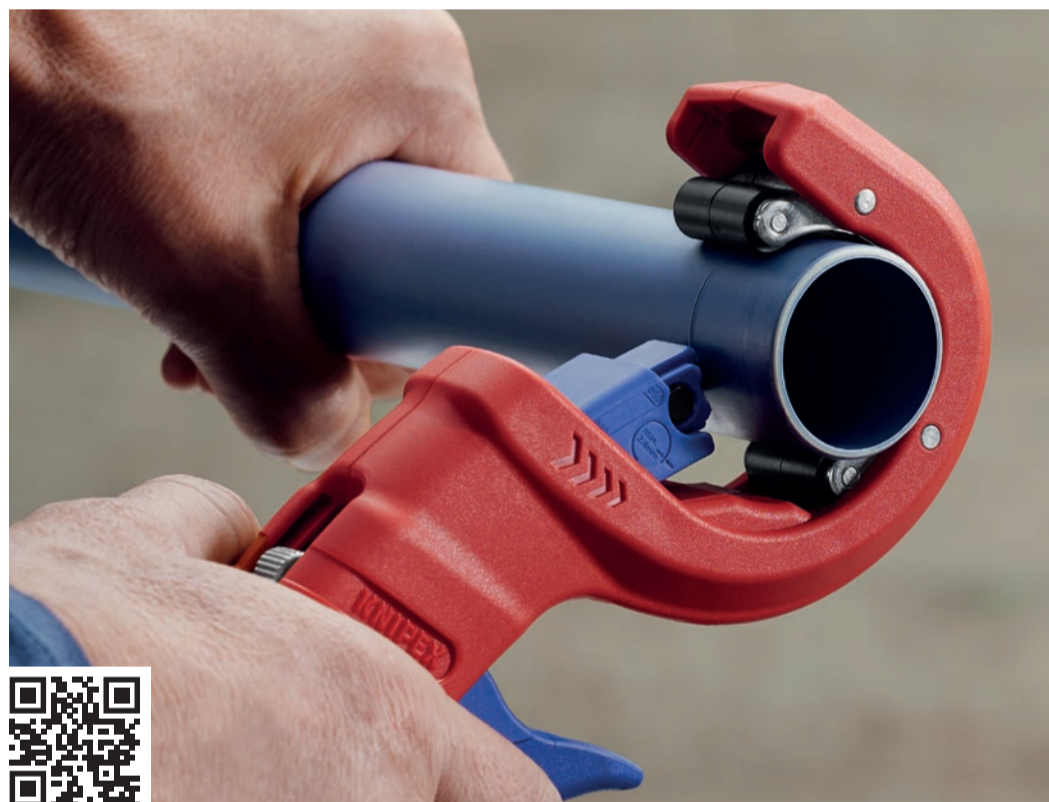
Die zweistufige Klinge trennt und bringt im gleichen Arbeitsschritt die Fase für fachgerechtes Zusammenfügen der Rohre an.
