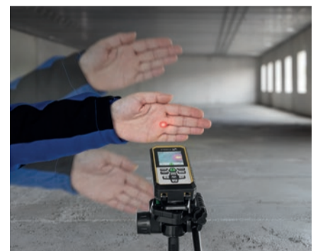
Die Messung kann beim Laser-Entfernungsmesser LD 530 BT durch Gesten statt Tastendruck kontaktlos ausgelöst werden. Das verhindert das Verwackeln, gerade auf lange Distanzen.
